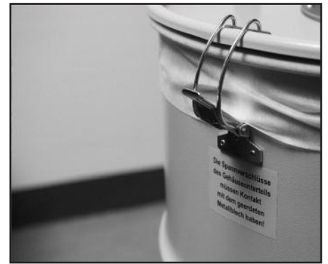
14. Beim Aufsetzen des Deckels ist darauf zu achten, dass einer der Spannverschlüsse des Gehäuseunterteils mit dem geerdeten Metallblech hat.
