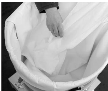
5. OPTIONAL: Bei Verwendung eines Filtervlieses diesen am Rand des Behälters lösen...
