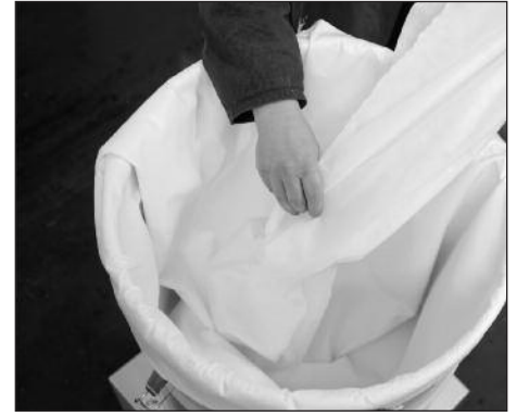
11. OPTIONAL: Bei Verwendung eines Filtervlieses diesen einsetzen...
