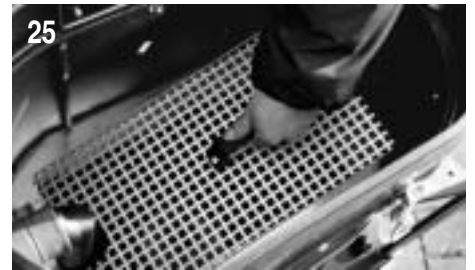
Verwirbelungssieb vorsichtig unter der Klemmschraube herausnehmen.
