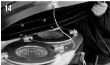
14 Gehäuseoberteil vorsichtig abnehmen. (auf das Erdungskabel achten!)
