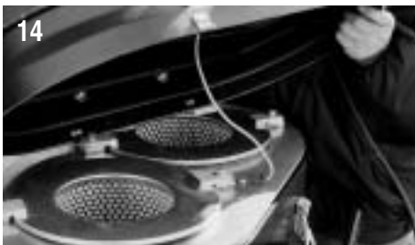
14 Gehäuseoberteil vorsichtig abnehmen. (auf des Erdungskabel achten!)
