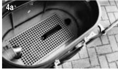
4a Befüllung durch Einsaugen von Flüssigkeiten oder manuelle Befüllung des geöffneten Saugers "von oben"
