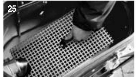
Verwirbelungssieb vorsichtig unter der Klemmschraube herausnehmen.
