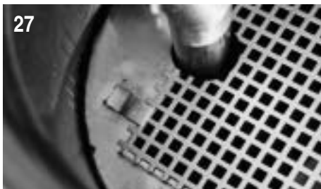
Beim Zusammenbau Verwirbelungssieb unter die Halteklemmen schieben.
