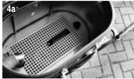
4a Befüllung durch Einsaugen von Flüssigkeiten oder manuelle Befüllung des geöffneten Saugers "von oben".
