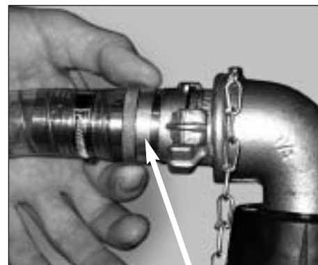
Schlauch am Abpumpanschluss anschließen. Unbedingt festschrauben!
