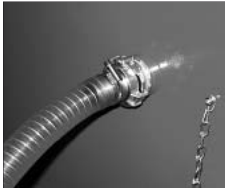
Mitgelieferten Schlauch am Abpumpanschluss anschließen.
