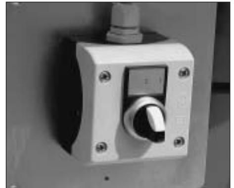
Pumpe einschalten. Flüssigkeit wird durch Pumpen-Schwimmerschalter automatisch abgepumpt.
