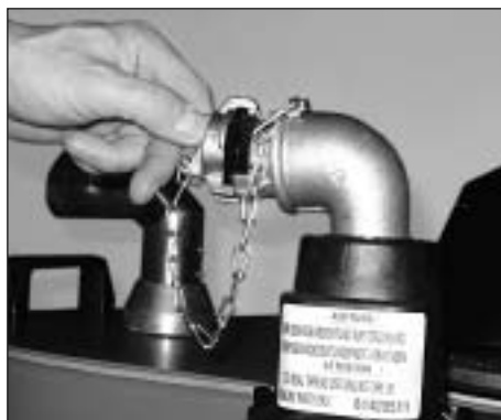
Verschlosskappe am Abpumpanschluss lösen.
